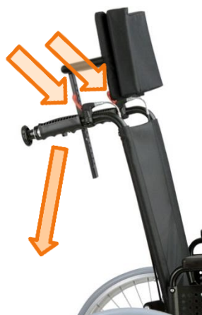
Fig. 2 – Ative a alavanca vermelha para reclinção das costas da cadeira.
